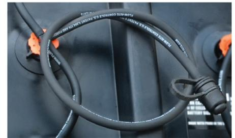
Corra la tapa guardapolvo que cubre el acoplamiento rápido, enrolle la línea de alimentación de agua y colóquela sobre la parte superior de la batería.
